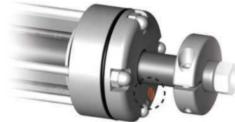
► Válvula hidráulica para ajuste de la segunda velocidad lenta al cierre
